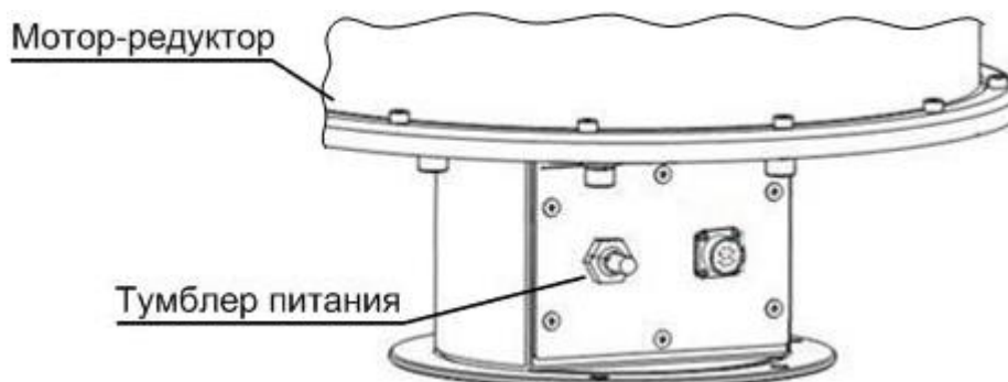
Рисунок 10 – Расположение тумблера питания на УПП
