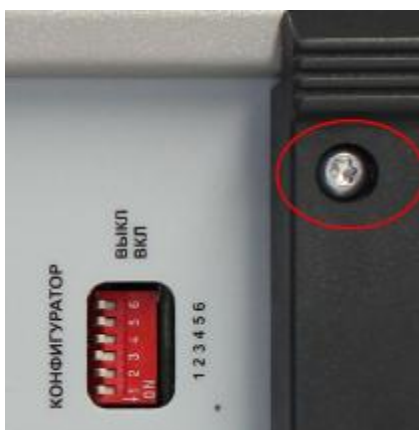
Рисунок 3 – Схема пломбировки от несанкционированного доступа (выделено).
